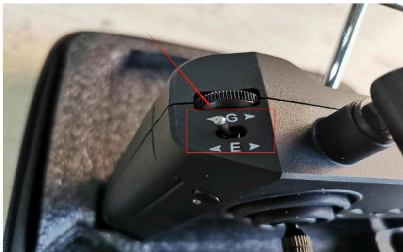
1. Decollo: spostare la levetta E verso sinistra (modalità ATT), spingere la levetta dell'acceleratore fino a oltre il 50% e poi rilasciarla quando il drone si alza nella posizione destra.
