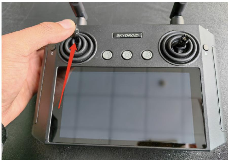
2. Atterraggio: Abbassare la levetta dell'acceleratore al 45% e tenerla premuta, così il drone atterrerà lentamente. Dopo che il drone ha toccato terra, abbassare completamente la levetta dell'acceleratore e mantenerla premuta per 3 secondi; in questo modo, tutti i motori smetteranno di funzionare.
