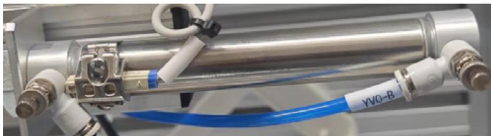
**Nota:** Per garantire il corretto movimento del cilindro e completare con precisione l'azione appropriata, basta scambiare la direzione di ingresso e uscita (implementato dalla valvola a solenoide) per cambiare il movimento di estensione e ritrazione del cilindro. Sui due lati del cilindro, sono presenti gli interruttori magnetici utilizzati per rilevare se il cilindro si è posizionato correttamente.
